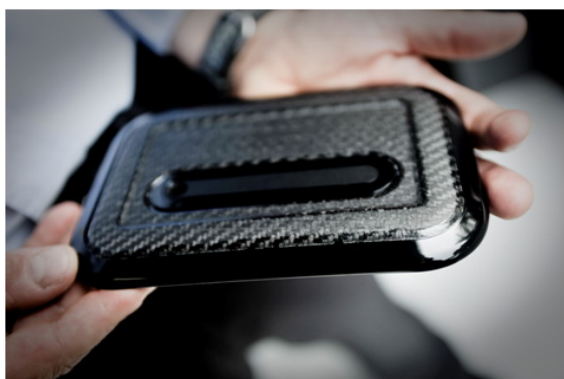
PIÈCE HYBRIDE, EN COMPOSITES RENFORCÉS DE FIBRES DE CARBONE ET SURMOULÉS EN INJECTION PLASTIQUE, QUI COMBINE LES AVANTAGES DES DEUX MATÉRIEAUX SANS BESOIN DE FINITIONS.
