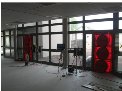
INSTALLATION D'ESSAIS D'UN BÂTIMENT DE GRAND VOLUME TYPE EPHAD
