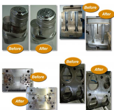
NETTOYAGE DE MOULES PAR ULTRASONS
