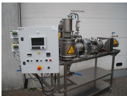
BANC DE SÉCHAGE PILOTE
