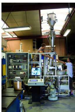
STATION AUTOMATIQUE DE DIVISION D'ÉCHANTILLONS
