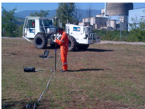
IMAGERIE GÉOLOGIQUE EN FRANCE - SOURCE VIBROSEIS POUR LA SISMIQUE RÉFLEXION
